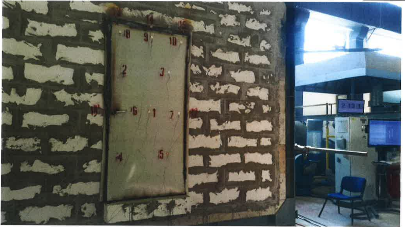
Şekil 20. Deney Sonunda Maruz Kalmayan Yüzeyin Görünüşü
