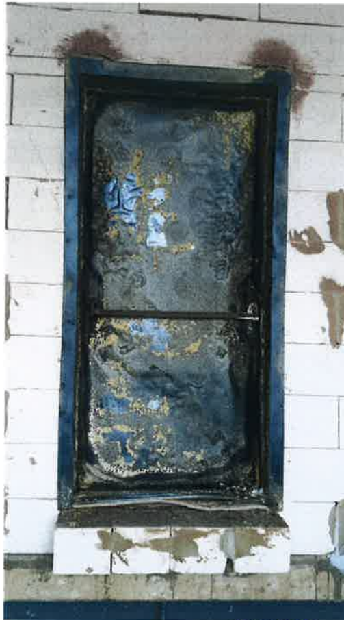
Şekil 21. Deney Sonunda Maruz Kalan Yüzeyin Görünüşü
